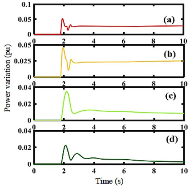
Fig. 13. Power variation of the EV aggregator (a) PSO-PID (b) SCA-PID (c) PSO-FOPID (d) SCA-FOPID
