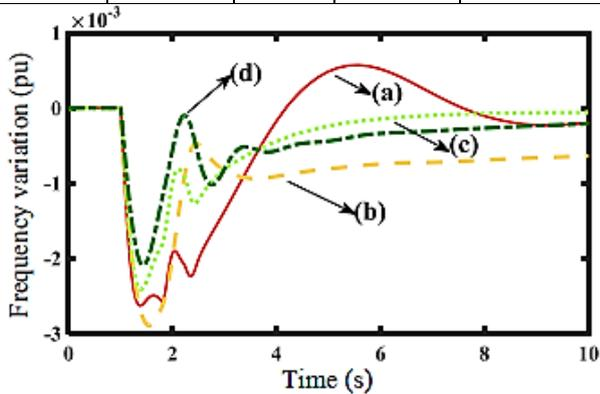
Fig. 11. Frequency variation of the LFC scheme (a) PSO-PID (b) SCA-PID (c) PSO-FOPID (d) SCA-FOPID
