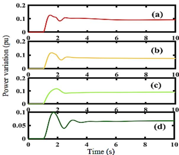
Fig. 12. Power variation of the generator (a) PSO-PID (b) SCA-PID (c) PSO-FOPID (d) SCA-FOPID
